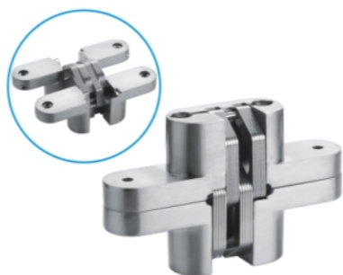
型号: HCG007 (不锈钢弹簧暗铰链) 尺寸: 25X118X18mm (内置弹簧, 有自动闭门功能但闭门力不可调节)
