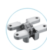
型号: HAG011 (锌合金弹簧暗铰) 尺寸: 19X95X13mm (内置弹簧,有自动闭门功能但闭门力不可调节)
