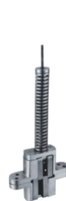
型号: HAG010 (锌合金弹簧暗铰链) 尺寸: 28X118X22mm (带弹簧暗铰,有自动闭门作用闭门力大小随弹簧预紧力大小而改变)
