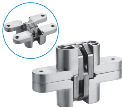
型号: HAG009 (锌合金弹簧暗铰) 尺寸: 25X118X18mm (内置弹簧,有自动闭门功能但闭门力不可调节)
